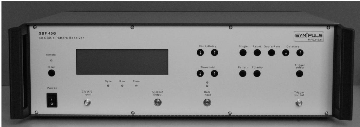
**Selbstsynchronisierender, breitbandiger Bitmusterempfänger mit Fehlerzähler**
